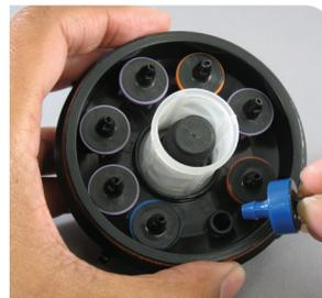
Hilfreicher Tipp: Tropfer wie abgebildet immer mit dem spitzen Ende (Zugangswiderhaken) oder dem Gewindeende nach oben installieren
