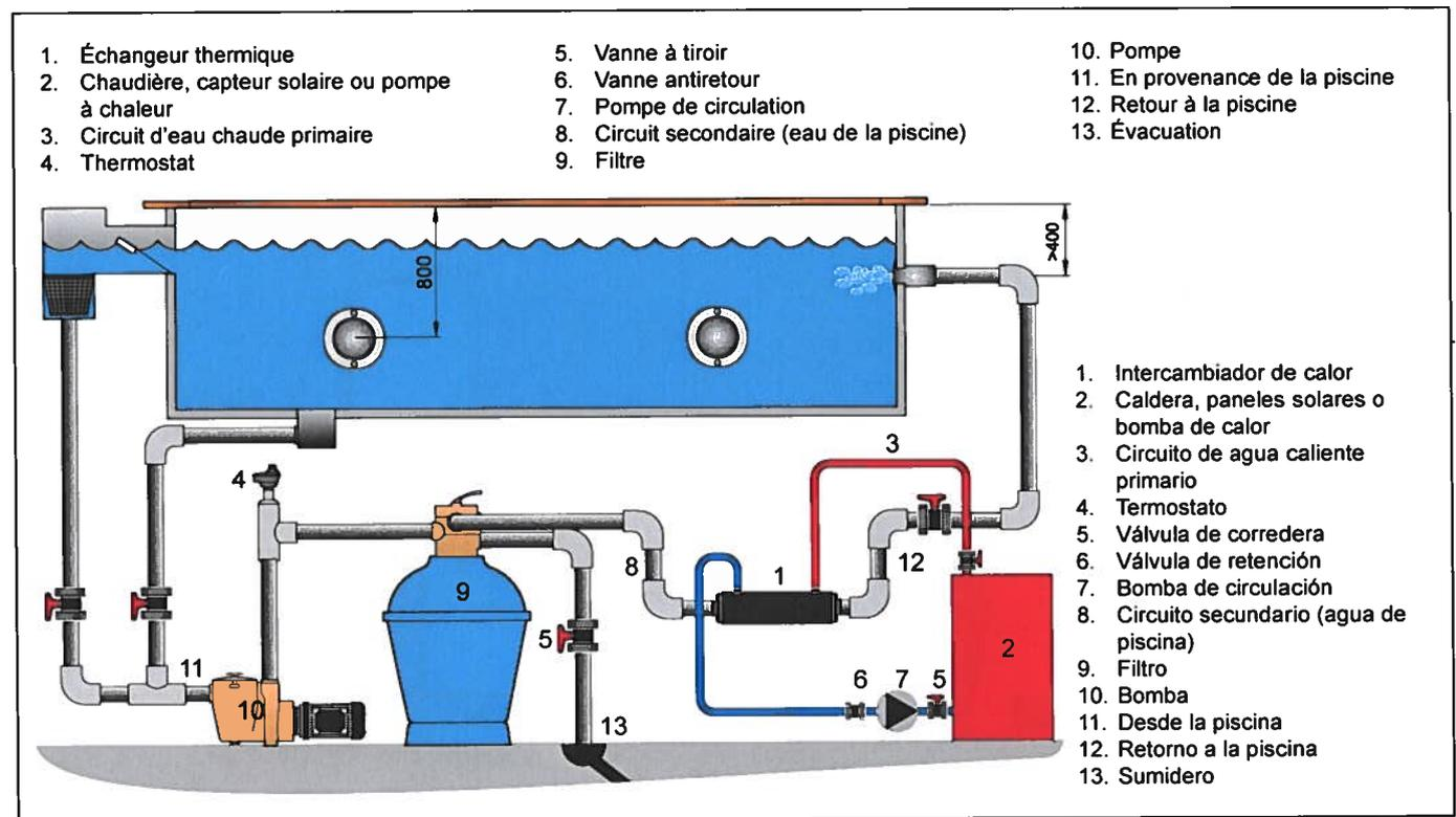
Instalar el intercambiador de calor según el plano (adjunto).
