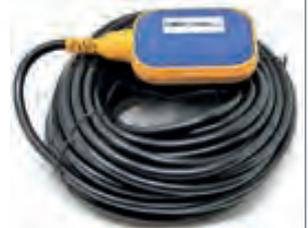
Der Schwimmer wird durch die steigende Flüssigkeit angehoben, bis bei einem Winkel von 50° zur Horizontalen ein Schaltvorgang ausgelöst wird. Der Schwimmerschalter kann durch eine Verschraubung seitlich oder bei offenen Behältern von oben in die Flüssigkeit gehängt werden.
