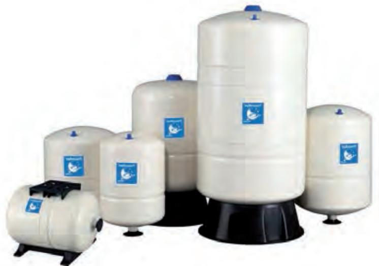
Die PressureWave™-Behälter sind vielseitig einsetzbar und ideal als Puffer-, Steuer- oder Ausdehnungsgefäße u.a. in Druckerhöhungsanlagen, vor Wasserwärmern, in Bewässerungsanlagen oder als Wasserschlagdämpfer geeignet. Anschlüsse 1" VA Vordruck 1,9 bar, max. Druck 10 bar.
