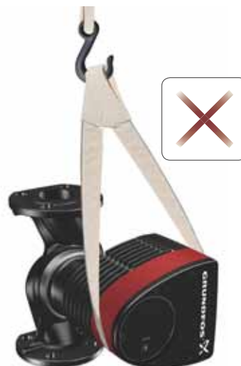
Fig. 6 Forkert løft af pumpen
