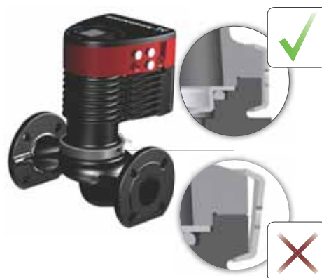
Fig. 15 Montering af pumpehovedet i pumpehuset
