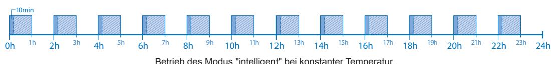
Betrieb des Modus "intelligent" bei konstanter Temperatur
