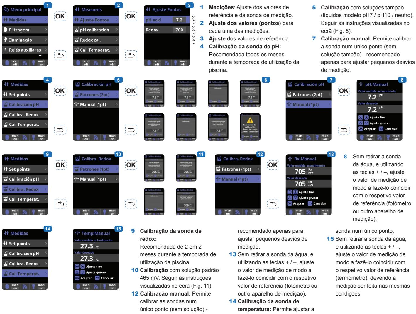
**1 Medições:** Ajuste dos valores de referência e da sonda de medição.
