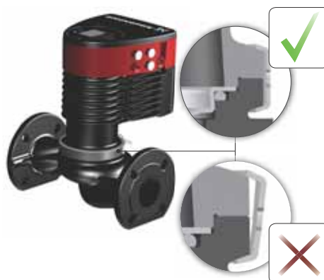
Rys. 15 Montaż głowicy pompy na korpusie pompy
