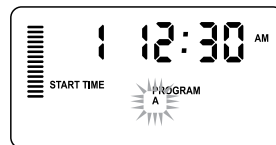
Exemple d'écran clignotant en maintenant enfoncé le bouton PRG
