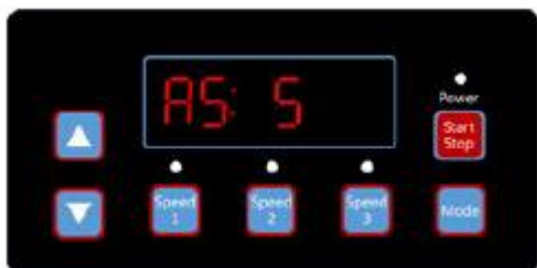
(Diagram 6.27, automatisk start tæller ned, 5 sekunder tilbage)
