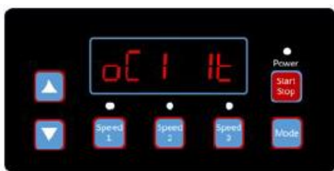
(Diagram 6.25, Automatisk gendannelse, fejlplysninger OC1, fejltid 1)
