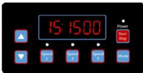
(Diagram 6.12, Planlæg 1 Hastighed, standard 1500rpm)
