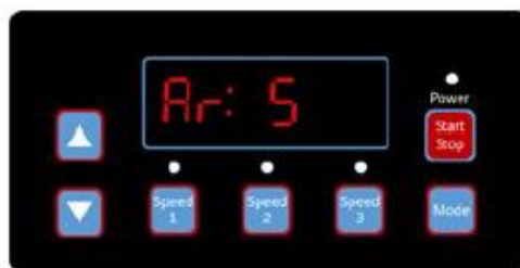
(Diagram 6.26, automatisk genoprettelse tæller ned, 5 sekunder tilbage)
