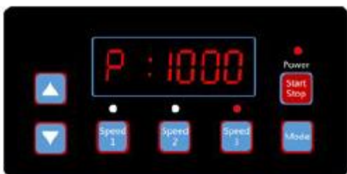
(Diagram 6.9, Strømforbrug visning, Hastighed 3)
