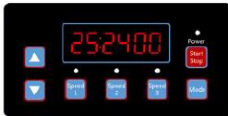
(Diagram 6.16, Planlæg 2 Hastighed, standard 2400rpm)
