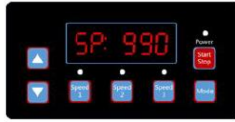
(Diagram 6.11, 1000rpm tryk én gang på "Ned")
