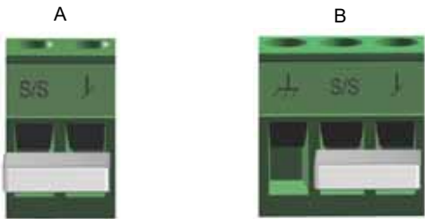
Abb. 35 Digitaleingang im Schaltkasten A: Mit Stecker angeschlossene Ausführungen B: Mit Klemmen angeschlossene Ausführungen
