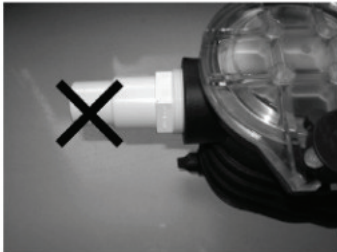
Keine Reduzierung der Saug- und Druckleitung
