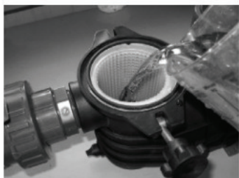
Amorcer la pompe (sinon risque de fonctionnement   sec). PERTE DE GARANTIE!!!
