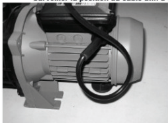
CORRECT! Evite l'entr e de l'eau par le c ble  lectrique.
