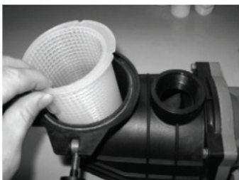
T gliche Reinigung des Filterkorbes!
