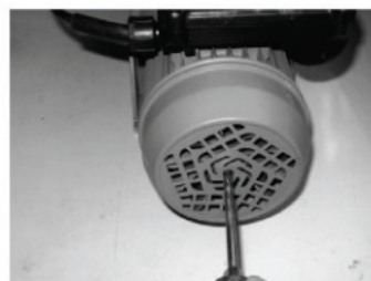
Afin d' viter le blocage de la garniture m canique, faire tourner l'axe par le ventilateur avant mise en marche ou apr s arr t prolong .
